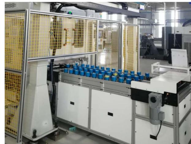
常规桁架机械人工况布局图
