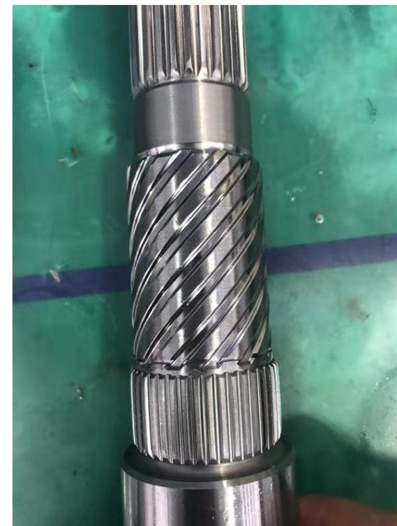
油槽大径磨削完成
