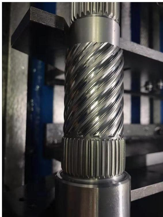
螺旋油槽搓制完成
