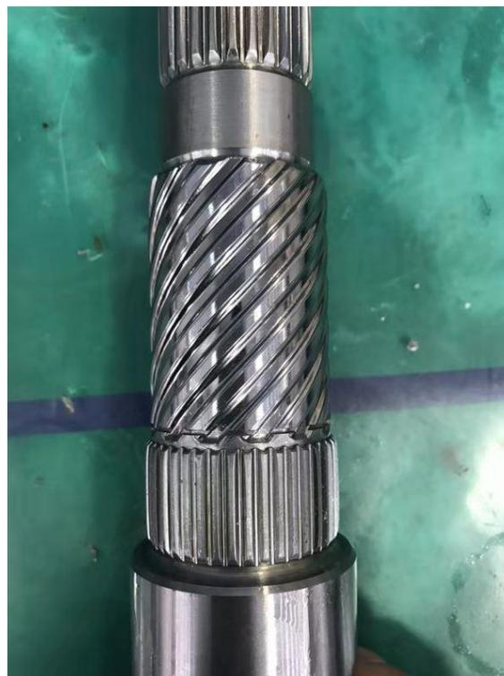
油槽大径车制完成
