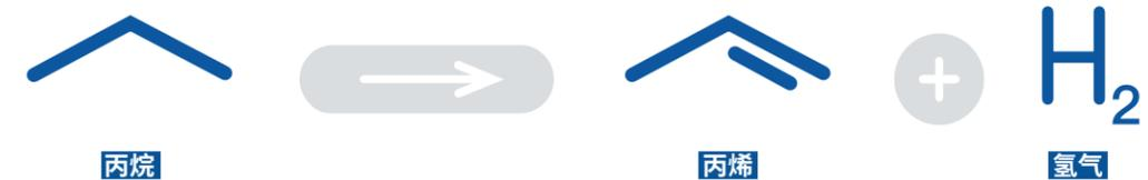
丙烷脱氢技术采用了一种更为简单的生产工艺，将单一进料 (丙烷) 转化为主要产物 (丙烯)，并有选择性地将副产品 (氢气) 用作燃料，或运输出厂用于其他更高价值的用途。丙烷脱氢装置能够轻松实现与上游丙烷原料或下游聚丙烯
