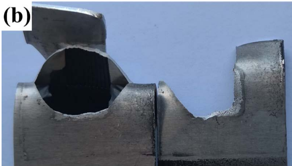
铝合金超声波焊接接头疲劳断口宏观形貌
