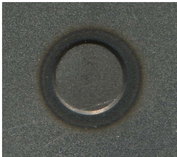
实心圆形电极焊点表面形貌
