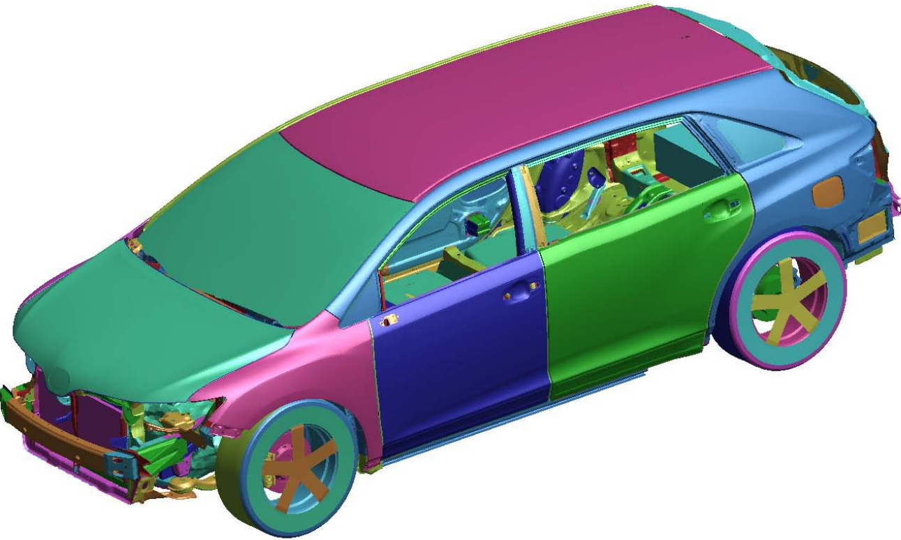
拉伸的Toyota Venza 碰撞用有限元模型
