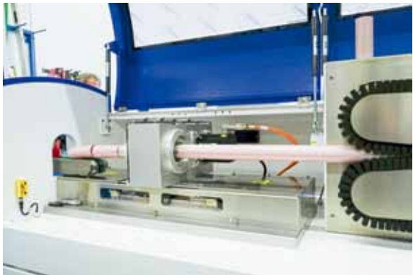
■ VKollmorgen 伺服驱动器通过直线电机和旋转刀来确保管道的完美切割，带 AKM 伺服电机 a/s 驱动器的切割单元通过 ICH 直线电机与生产速度同步定位
