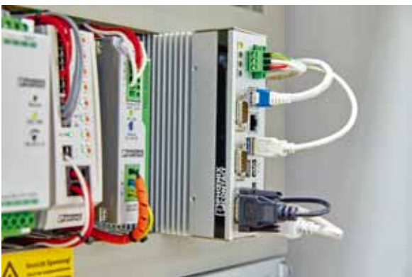
■ 由于紧凑和无冷却风扇结构使得这种嵌入式计算机几乎可以在任何实际应用中装入
