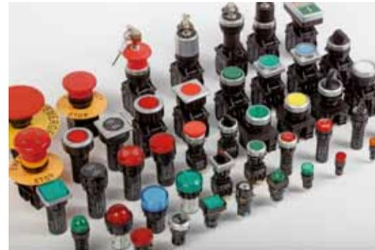
LA42 系列按钮分为圆形、方形两类，产品品种繁多，规格齐全，满足客户的不同需求。按钮表面经特殊加工工艺处理，色泽鲜艳、醒目，长期使用不磨损不退色按钮选用进口尼龙为材料，阻燃等级高达 V-0 级，安全可靠，同时特有的防水装置，保证了产品的高防护能力，加装防护罩后，防护等级更可高达 IP67，按钮，触点模块最多可装三片，触点数最多为六付触点。LA42 系列产品具有优良的抗振动性，使用寿命长。LA42 系列按钮由钮头、连接支架、触点模块三部件组成，这三部件联接采用国际通行的无紧固件自锁联接，安全、可靠、拆装方便，（一个人即可操作），寿命长。
