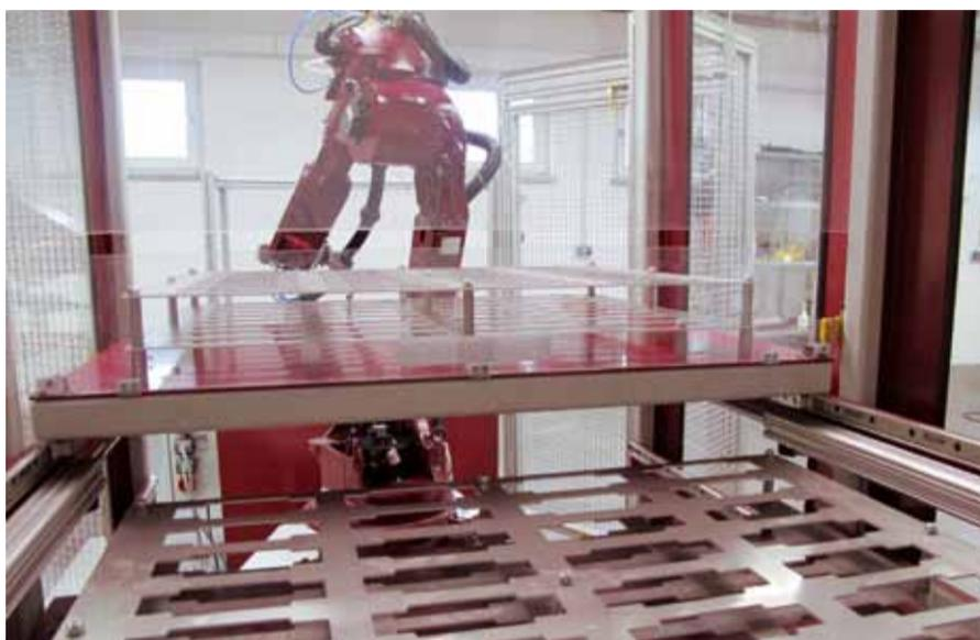
■ 借助工业自动机械和 Actuator System Line 实现包装和装盘阶段的自动化
