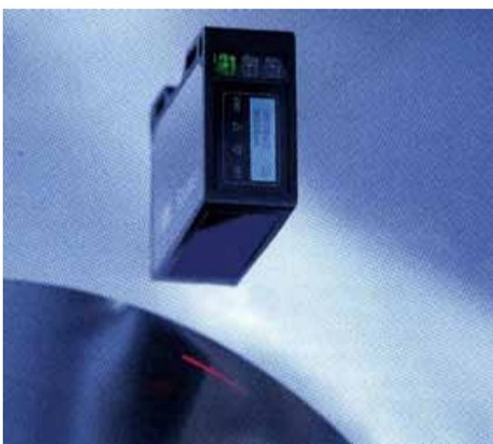
■ 堡盟激光测距传感器具有不同的聚焦范围，从 0.7m 的分辨率开始，重复精度为 0.1m，最大测量距离为 70 mm
