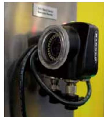
iVu Gen2 TG（一体式）、iVu Gen2 RG（分体式）将三个高级的传感器功能结合在一起，iVu Gen2 TB（一体式）、iVu Gen2 RB（分体式）作为专业成像式读码器，其高解析能力，能够读取工业上常用的一维码及二维码，一次可读取多个相同或不同种类的条码。
