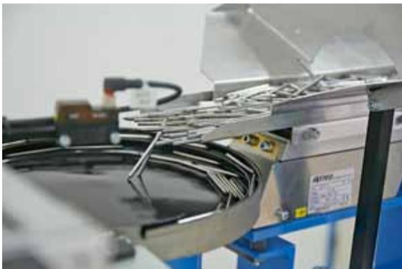
■ 从一个储料仓里出来的金属柱螺栓首先到达一个螺旋输送机,目的是为了零件缓冲装置将工件纵向安置在一个线性的输送段上
