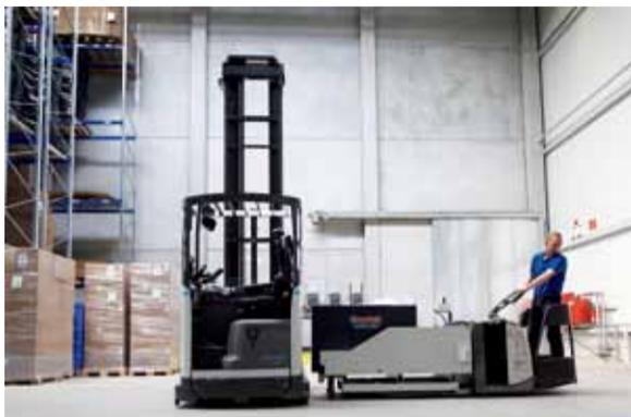
■ 物流中心仓库工作中使用的搬运设备每天要更换两次。因此 Centrotherm 公司采用了蓄电池更换站更换仓库运输设备的蓄电池
