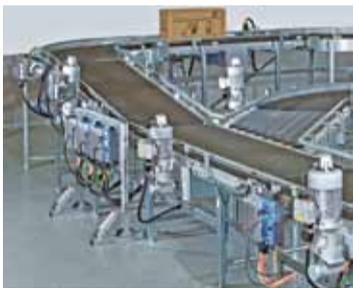
诺德将减速机整合到驱动系统配置方案中，从而为仓库、配送中心、内部物流系统或行李输送设备的系统工程师和操作人员提供完整的解决方案。这些解决方案支持所有常见的现场总线 and 工业以太网协议接口。应用于电源装置、传感器和通信线路的连接插头可确保实现无故障的快速安装和维护。
