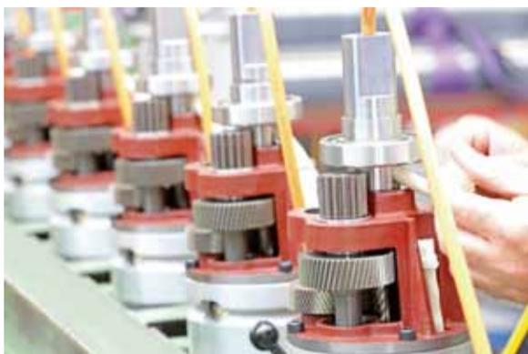
■ 用于输送系统的高性能驱动器,如电动滚筒使用的优质的滚动轴承:Interroll公司在生产电动机成套部件时采用单件流水作业
