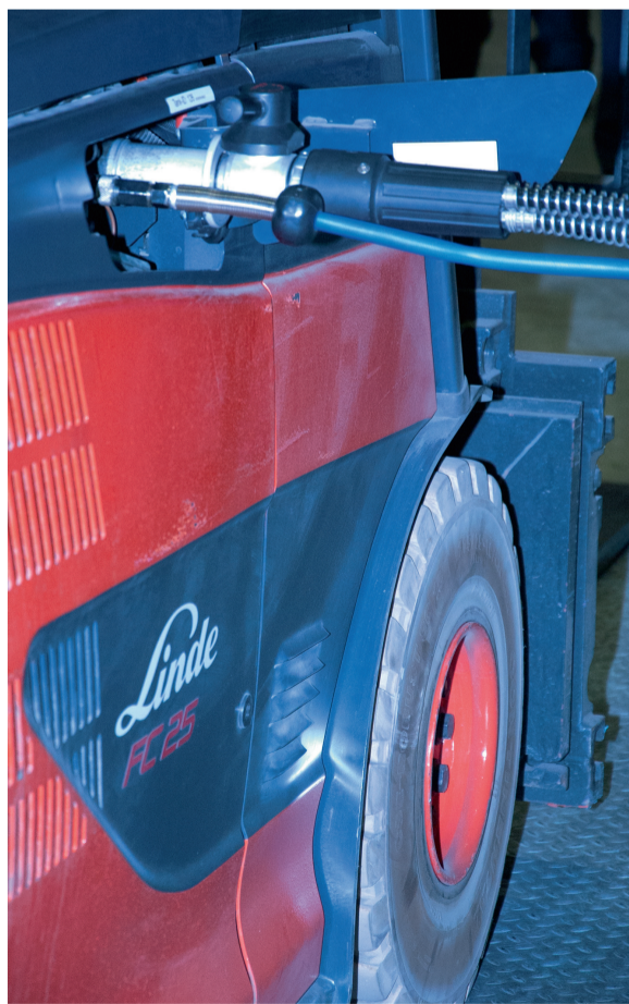
■ 通过粗的黑色管为堆垛机输入氢。细的蓝色管则是用于通风排气
