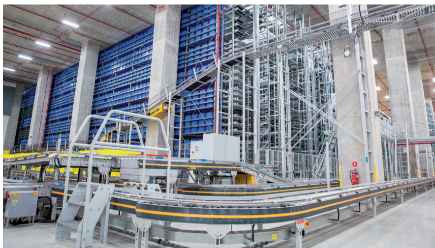
■ DHL Supply Chain公司新加坡地区物流中心ARC共有72000的仓储位置，130辆机器人控制的运输车
