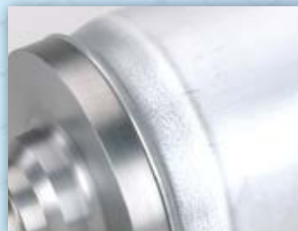
磁力脉冲焊 — 高精度、零 惰性气体排放， 可以焊接不同的金属。
