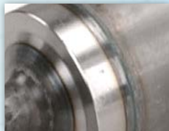
磁推力电弧焊 — 允许较低的初始不平衡度， 改善了乘驾质量。
