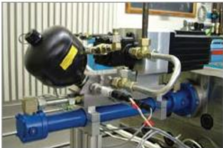
带有梭阀的结构实验装置
