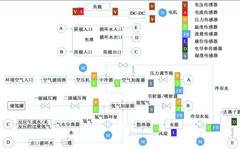
图表 60 氢燃料电池系统中关键零部件是电堆与空压机
