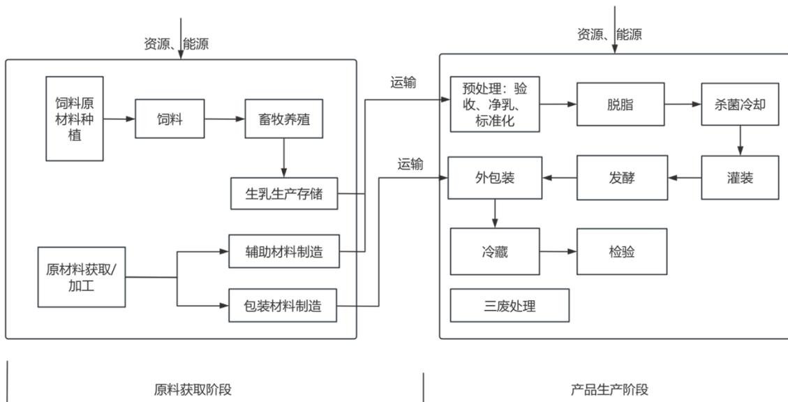
图1 乳制品系统边界图（以脱脂巴氏杀菌发酵乳生产过程为例）
