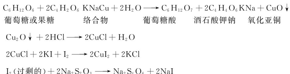
硫代硫酸钠标准溶液空白试验滴定量减去其样品试验滴定量得到一个差值,由此差值便可计算出还原糖的量。
