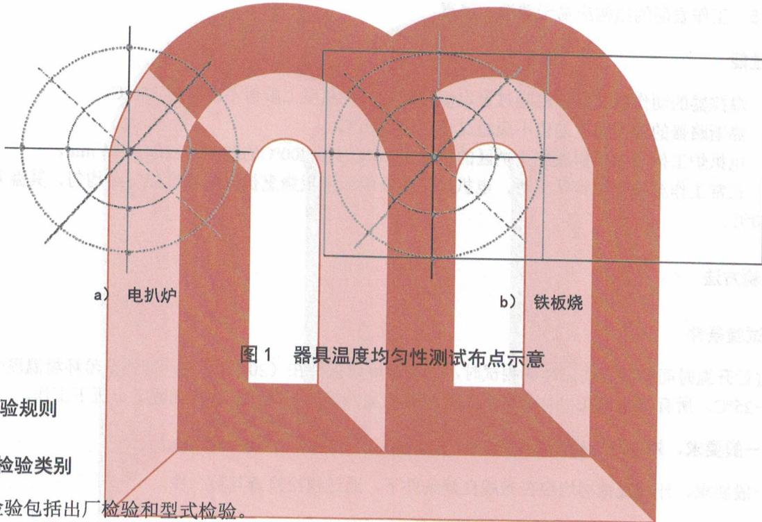
图1 器具温度均匀性测试布点示意
