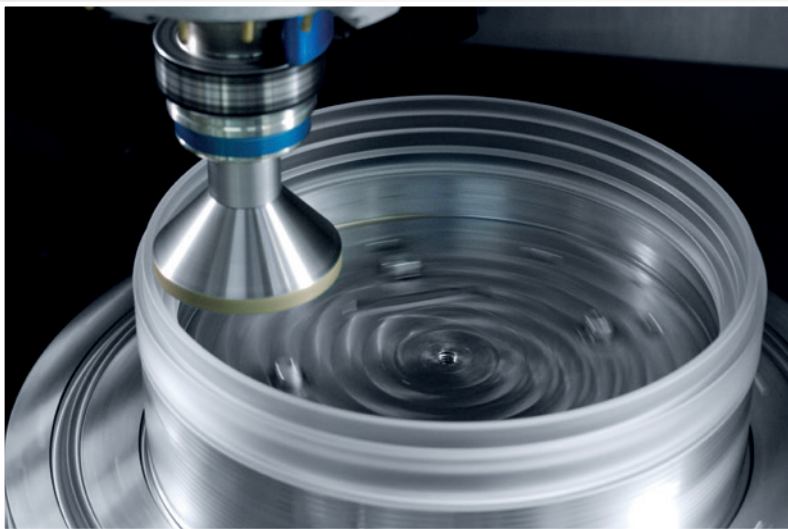
ULTRASONIC超声加工可实现 Ra = 0.05 \mu\text{m} 的高表面质量。
