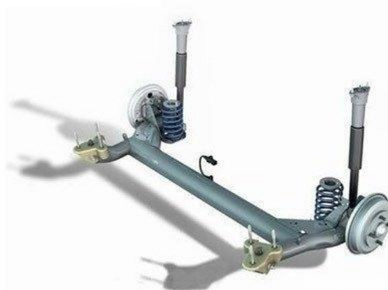
图 4 托臂扭转梁式悬架
