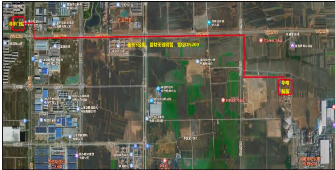
图 23：次高压纯氢管道路由
