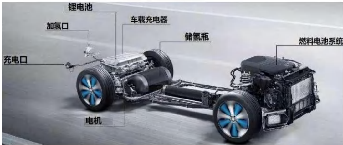
图 42：燃料电池汽车结构
