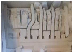
(1)大尺寸大厚度砂芯无机制芯技术，VOC中酚醛类零排放
