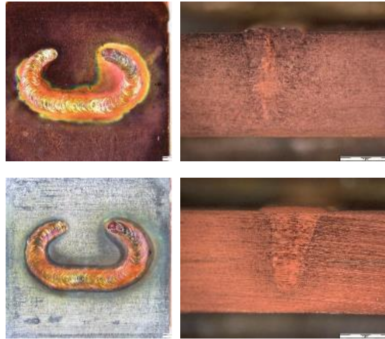
焊接接面图 典型材料厚度：0.5- 2mm 材料类型：ETP
