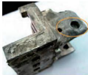
镁合金压铸过程中出现欠铸问题
