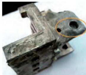
镁合金压铸过程中出现欠铸问题
