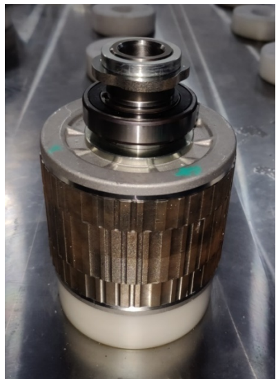
转子热塑工艺生产的转子
