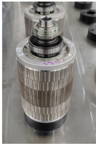
转子热固工艺生产的转子
