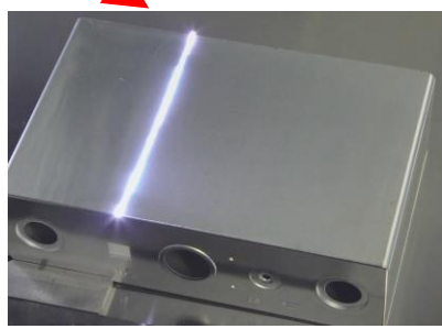
电芯表面清洗/结构化 (> 25 cm 2 /s)
