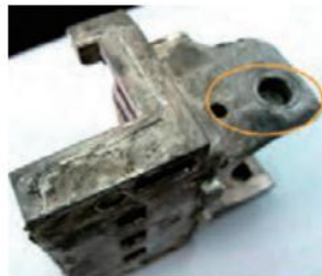
镁合金压铸过程中出现欠铸问题
