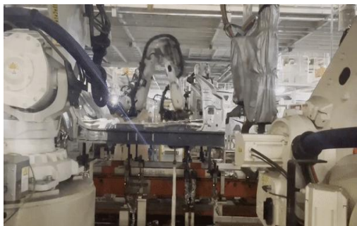
滚床定位传输过程
