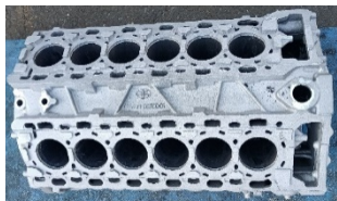
(1)链条室罩盖集成，超大尺寸铸件
