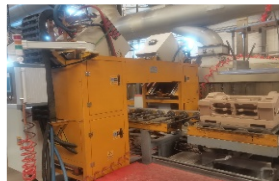
(1)缸套电磁感应加热技术提高缸套贴合度，国际首创
