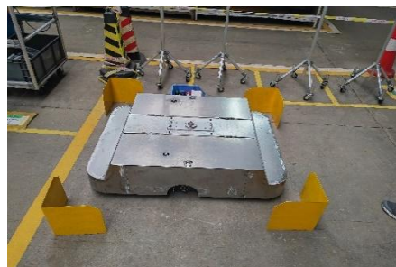
加工完成的壳体部分
