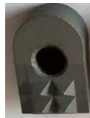
凸轮轴夹紧面最大角度误差±4度
