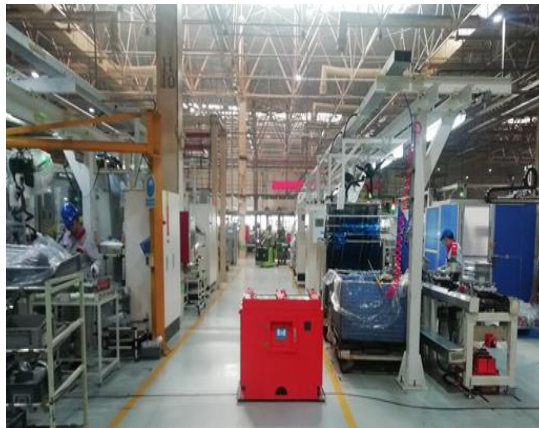
AGV小车, 驳运缸盖总成
