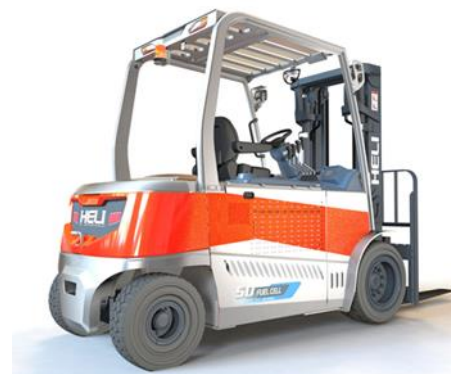
燃料电池叉车 搭载捷氢启源P3S
