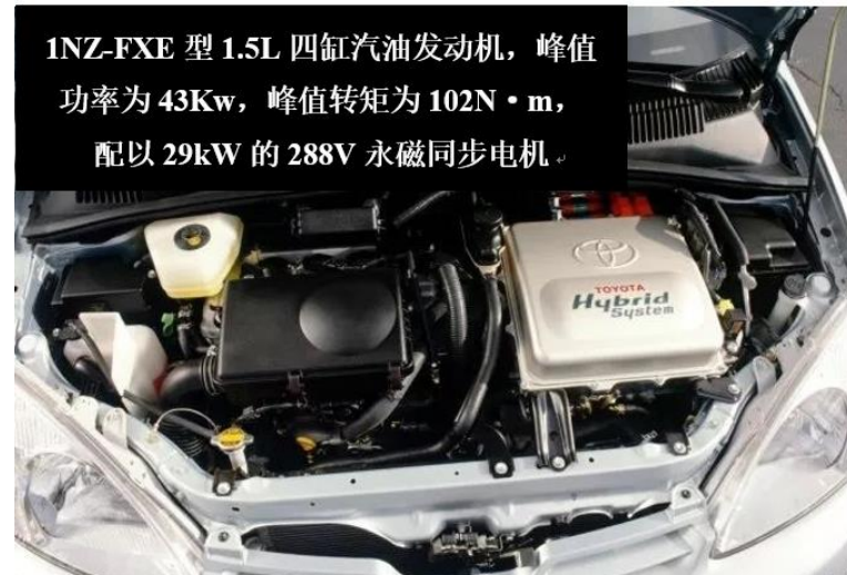
图4-4 第一代普锐斯混合动力汽车搭载的发动机和电机
