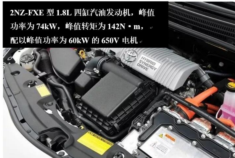
图4-7 第三代普锐斯混合动力汽车搭载的发动机和电机
