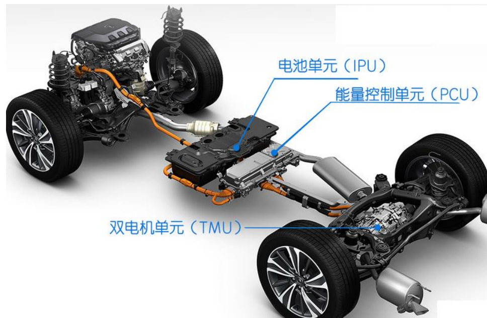
图4-62 讴歌混合动力汽车结构示意图
