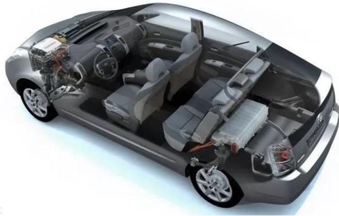
图4-5 第二代普锐斯混合动力汽车透视图
