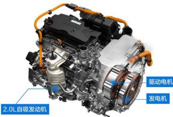
图4-49 第三代本田i-MMD双电机混合动力系统
