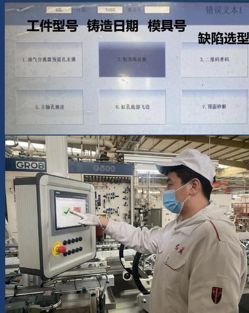
毛坯缺陷与二维码绑定上传整线
