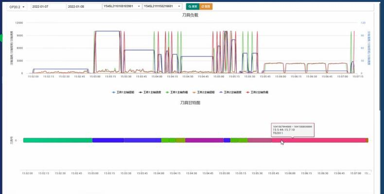
首尾件刀具加工主轴扭矩对比 (4GC三代缸体线实例)
