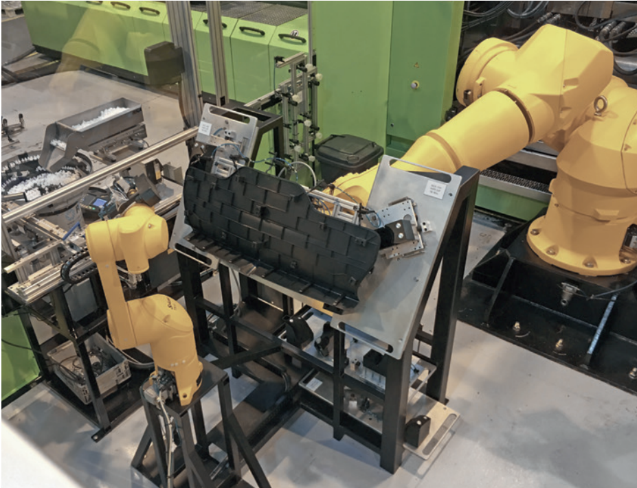
两台史陶比尔六轴机器人负责WHS Plastics开发的用于后挡板的成型零件取出和组装
