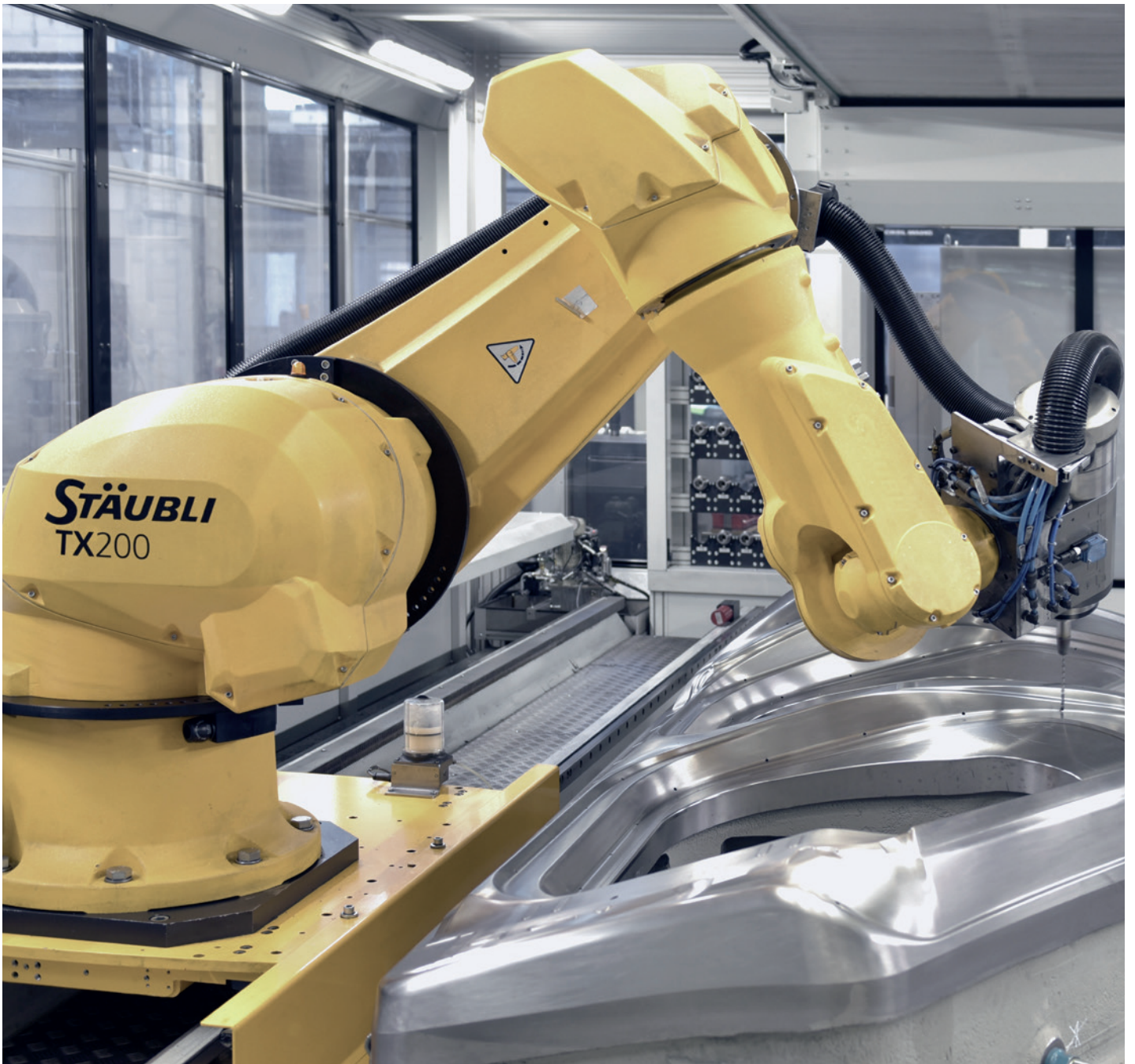
横向轨道极大地扩大了机器人的工作范围
