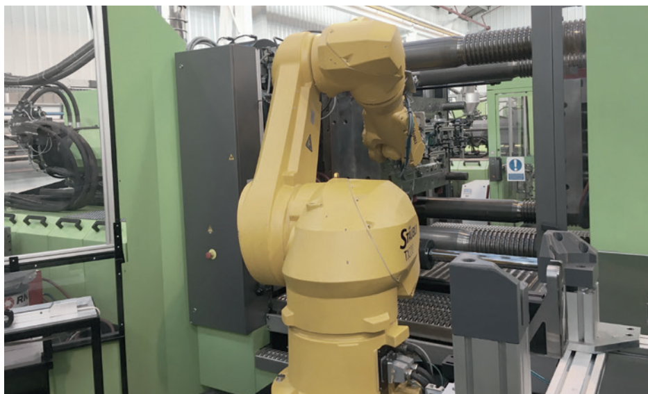
TX200从注塑机上取下后挡板组件, 并将其交给单元中进一步处理。
