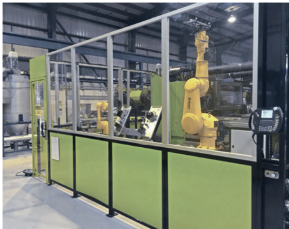
在全自动单元内, 史陶比尔机器人可确保高重复性。
