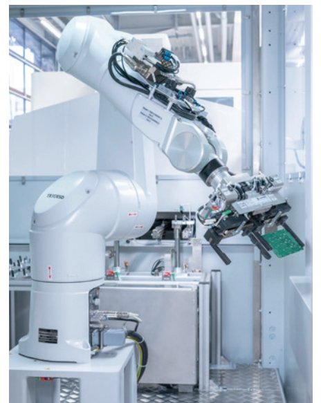
史陶比尔 TX90L ESD防静电版本机器人处理印刷电路板
