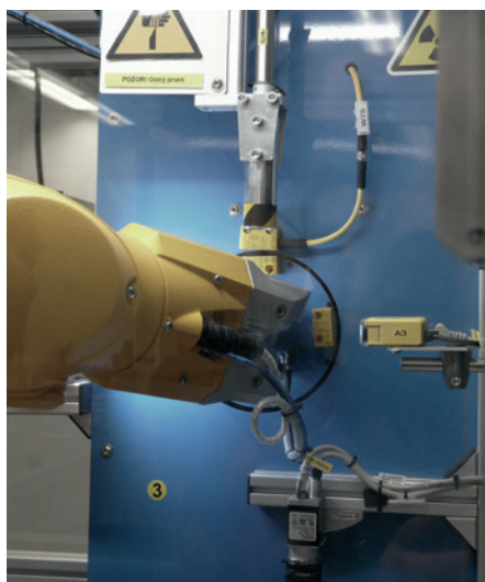
在检验过程中，夹具在密封的X射线室内将零件旋转180度。
