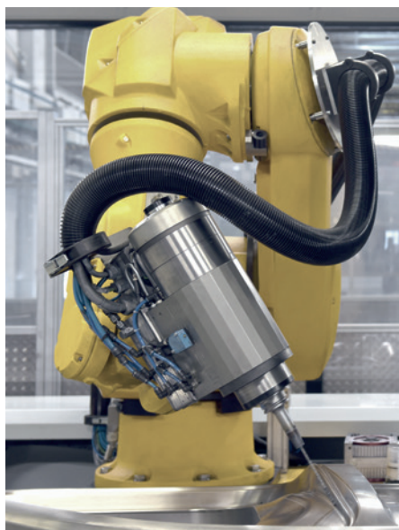
在钻深孔时,六轴模型具有出色的动态控制和刚性。图片:奥迪
