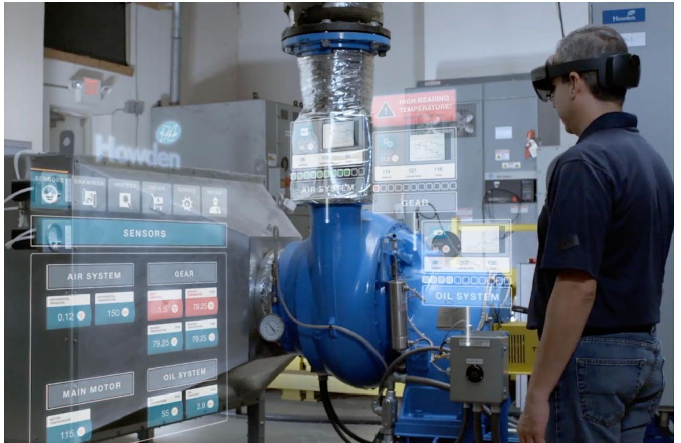
要访问操作说明，一线工作者可以在智能眼镜、智能手机或平板电脑上启动 Web 浏览器应用程序。基于 AI 的计算机视觉技术使用 AR 设备的摄像机来识别现实世界中的对象或工作区，将相关内容传递给一线工作者并显示在工作者的物理环境中的适当对象或工作区上。AR 设备可以像工作者那样查看现实环境，同时将数字信息投影到该环境上，以指导工作者执行某个任务，例如维修程序。
