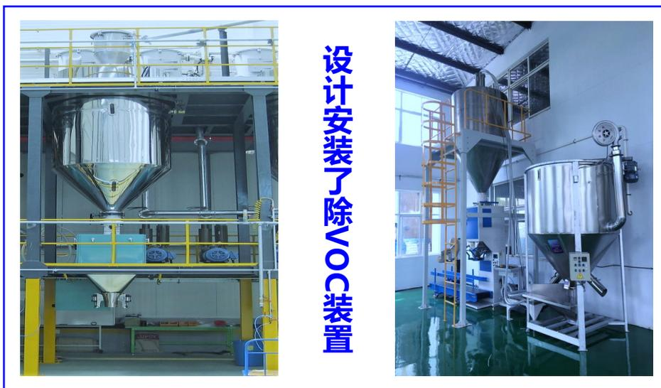
自主研发了PP专用除味母粒及改性料，并在装置上设计安装了负压除VOC装置，开发了多个车用环保PP牌号。
