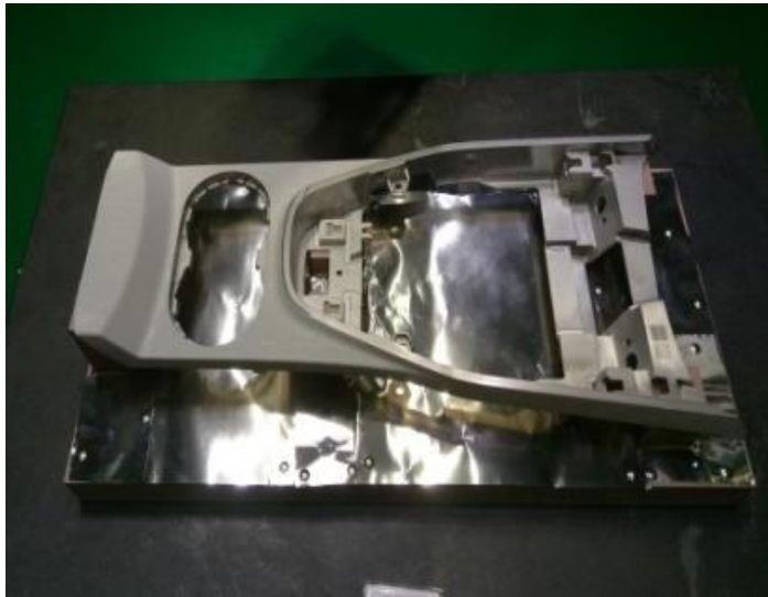
副仪表板快速样件 -- 铝件 Console RP--aluminum parts
