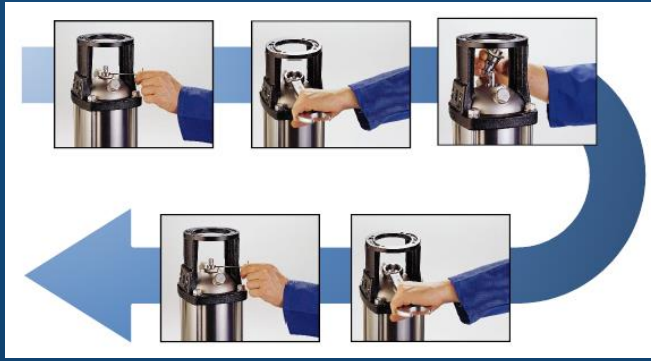
集装式轴封，便于维护、更换，操作安全
