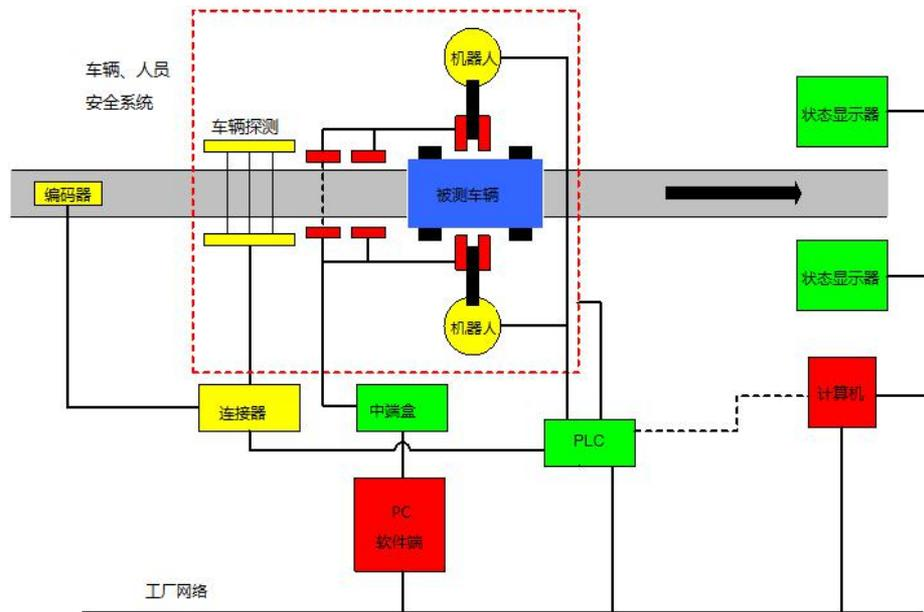
考虑到总装车辆颜色多样性和待测面造型复杂性，采用蓝紫双色激光器从不同角度进行测量。解决了如下问题：
