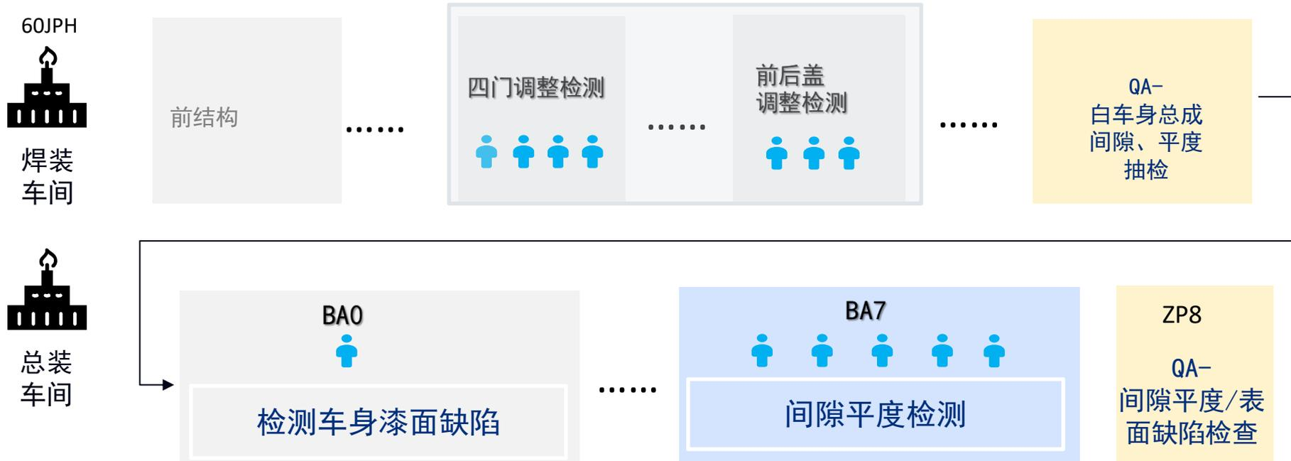
**背景：** 总装车间在商品车下线后进行车身间隙平度调整，并通过人工用塞尺进行检查，检查效率低下且不客观，检测精度随操作者的状态波动，导致一部分车辆在质保终检时不合格，浪费工时
