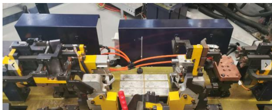
用于弧焊的水冷型散热铜板结构
