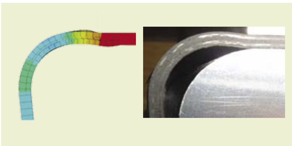
图片显示了复合材料的仿真结果与实际试验的对比，展示了基于LMS Samtech Samcef Composites软件，复合材料渐进损伤分析的新方法。
