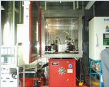
使用LMS Test. Lab振动控制的部件冲击和振动测试。
