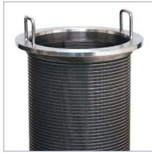
不锈钢过滤器可选滤芯采用楔形钢丝制成可过滤15-1125微米的杂质或采用孔式滤筛过滤较大固体杂质。
