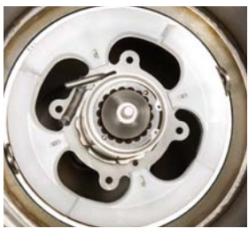
伊顿公司独特的弹簧承载清洁盘（这里展示的是MCS500型）可确保与滤筛紧密接触，以便均匀、彻底地清洁介质。
